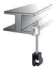
Tubo suspendido por barra roscada
