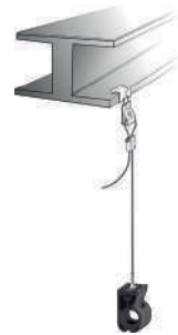
Tubo suspendido por cable
